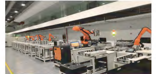
电学测试设备(新型FCT及自动测试线)
